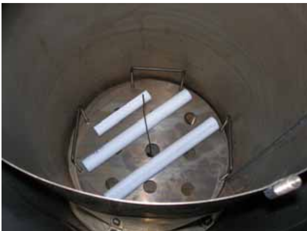
5 Заготовки ПТФЭ в опытной установке перед закалкой
