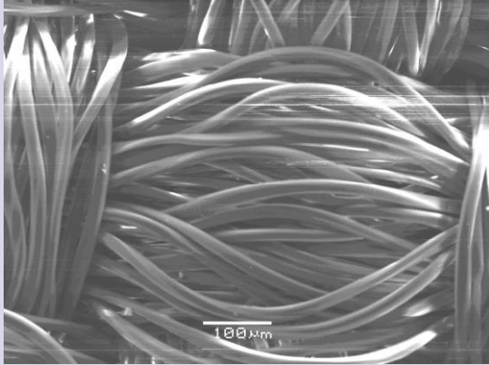
Изображение ПЭФ ткани с покрытием на основе препарата «Форум», нанесенного из среды СК-CO 2
