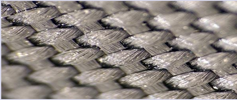
Структура полиэфирной ткани
