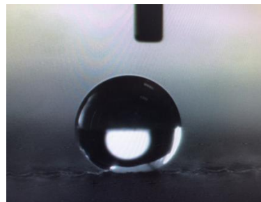
Фотография капли на поверхности ГПКМ (а),
